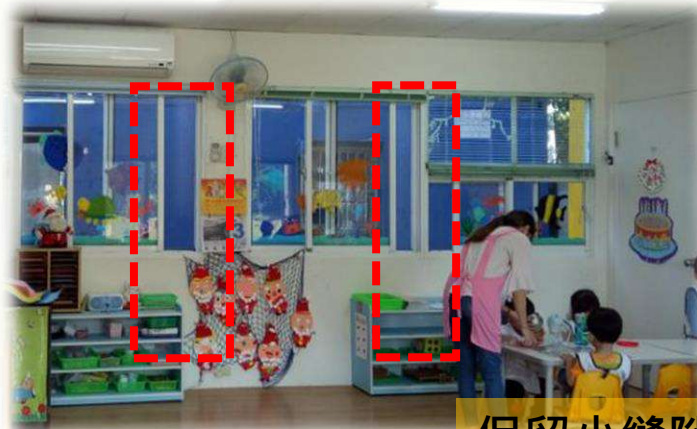
保留小縫隙開窗以適時 引入外氣並導出CO 2
